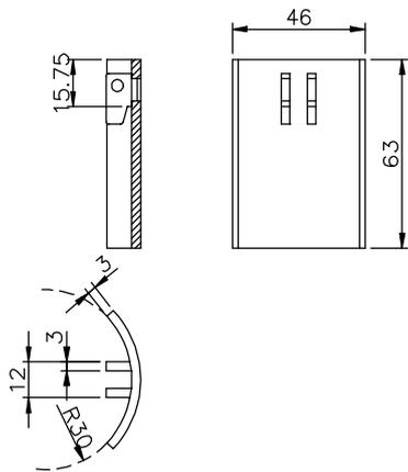
für Rundrohr  $\text{Ø}60 \times 2$  mm, 35 mm Teil.
