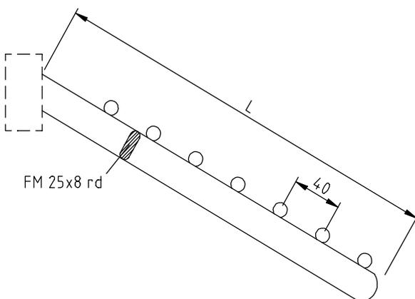
**Abhängearm:** -schräg, mit Kugeln-
