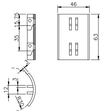
für Rundrohr  $\text{\O}60 \times 2$  mm, 35 mm Teil.
