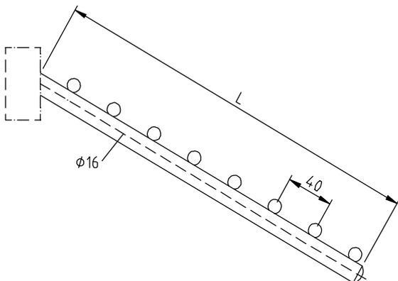
**Abhängearm:** -schräg, mit Kugeln-
