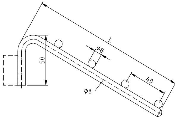
**Abhängearm:** -schräg, mit Kugeln-
