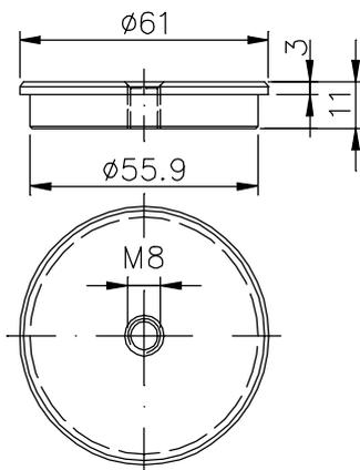
**Abdeckkappe:** für Rundrohr  $\text{\O}60 \times 2$  mm
