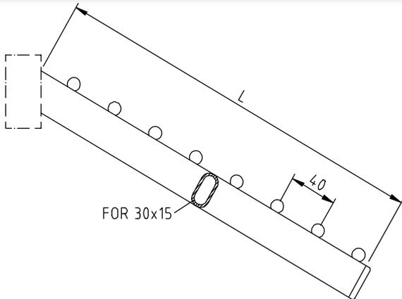
**Abhängearm:** -schräg, mit Kugeln-
