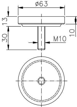
**Abschlusscheibe:** für Rundrohr  $\text{\O}60 \times 2$  mm
