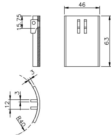
für Rundrohr  $\text{Ø}80 \times 2$  mm, 35 mm Teil.
