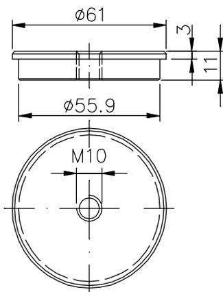
**Abdeckkappe:** für Rundrohr  $\text{\O}60 \times 2$  mm
