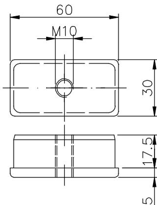
**Einschlagstück:** für Rechteckrohr 60x30x2 mm
