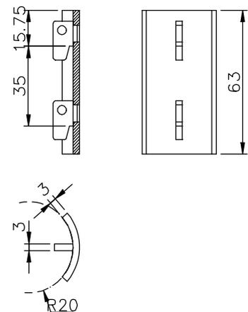
für Rundrohr  $\text{Ø}40 \times 2$  mm, 35 mm Teil.
