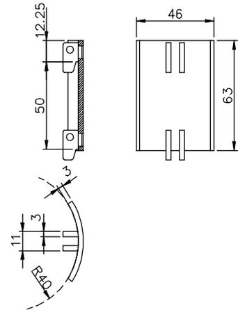
für Rundrohr  $\text{Ø}80 \times 2$  mm, 50 mm Teil.
