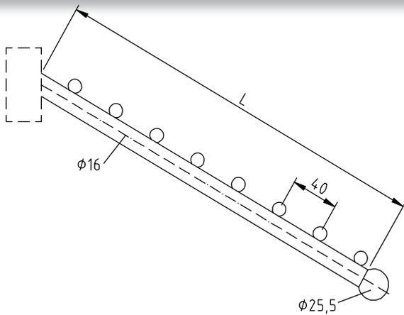
**Abhängearm:** -schräg, mit Kugeln-
