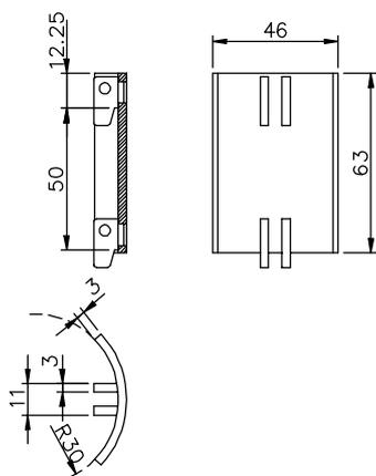
für Rundrohr  $\text{\O}60 \times 2$  mm, 50 mm Teil.
