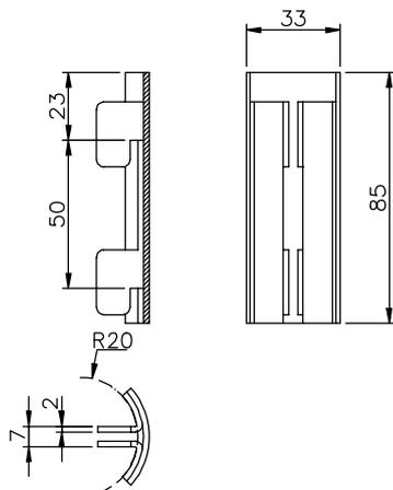
für Rundrohr  $\text{Ø}40 \times 2$  mm, 50 mm Teil.
