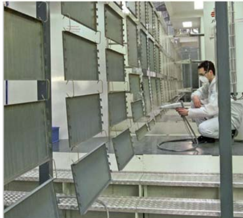
Die Pulverkabine besteht aus einer Handbeschichtungszone, einer vollautomatischen Kabine mit acht elektrostatischen Pistolen sowie einer zweiten Handbeschichtung. Quelle (zwei Fotos): Redaktion
